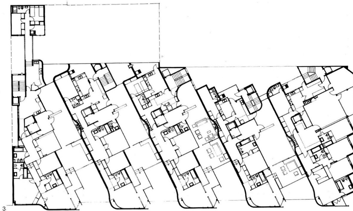
Figura 1: Planta tipo del Edificio Girasol de Coderch, 1964.
